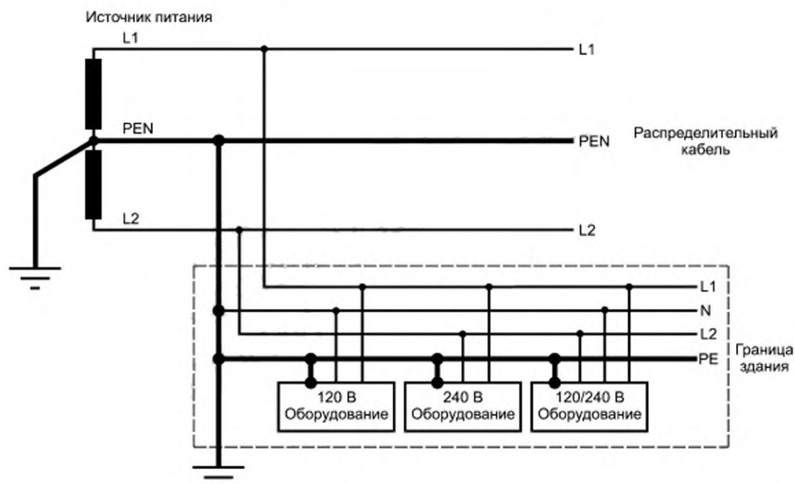
Функции защитного и нейтрального проводников совмещены в одном проводнике (PEN). Эта система широко используется в Северной Америке с напряжением 120/240 В.
