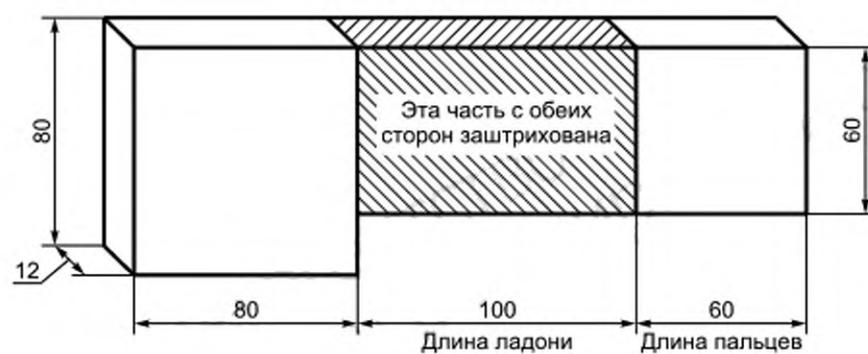
Материал: пластина из гибкого пенопласта толщиной 12 мм
