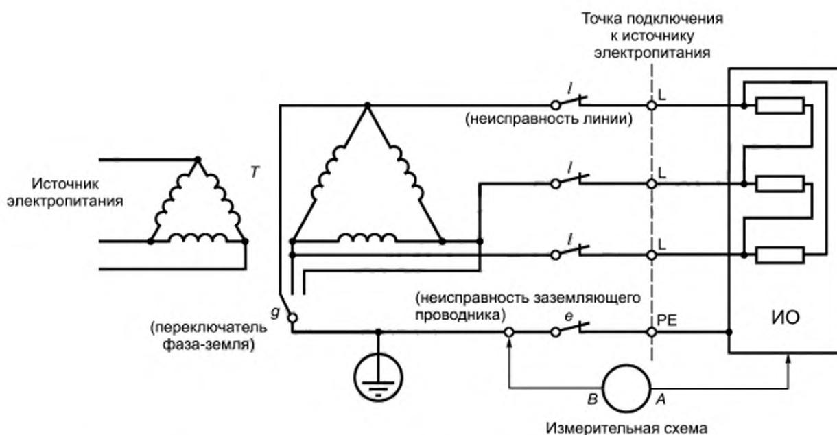
Рисунок 13 — Испытательная конфигурация. Соединение треугольником без заземления
