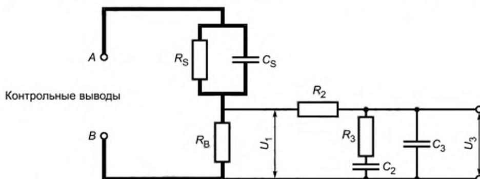
$$R_S = 1500 \text{ Ом}; \quad R_3 = 20000 \text{ Ом};$$
