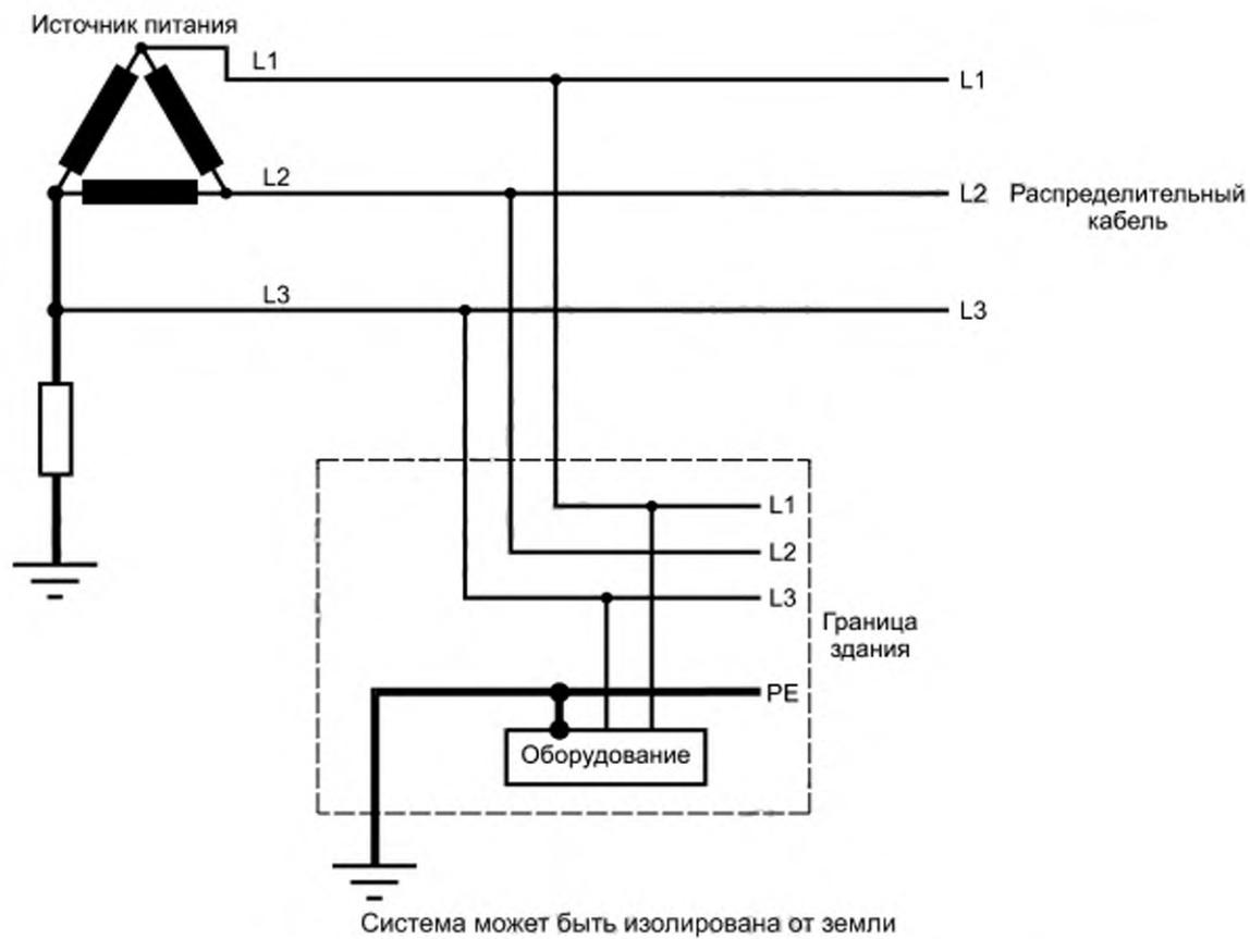
Рисунок J.8 — Пример трехфазной системы электроснабжения IT
