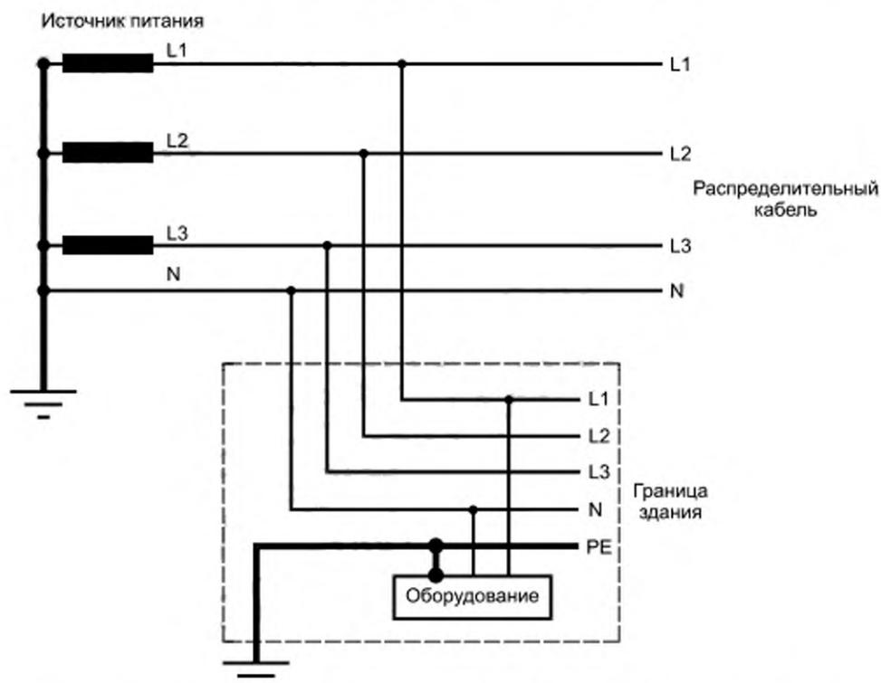
Заземленная нейтраль и независимое заземление оборудования
