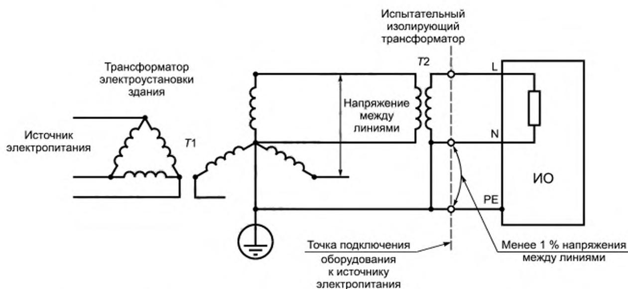
Рисунок 2 — Пример заземленной нейтрали испытательным изолирующим трансформатором
