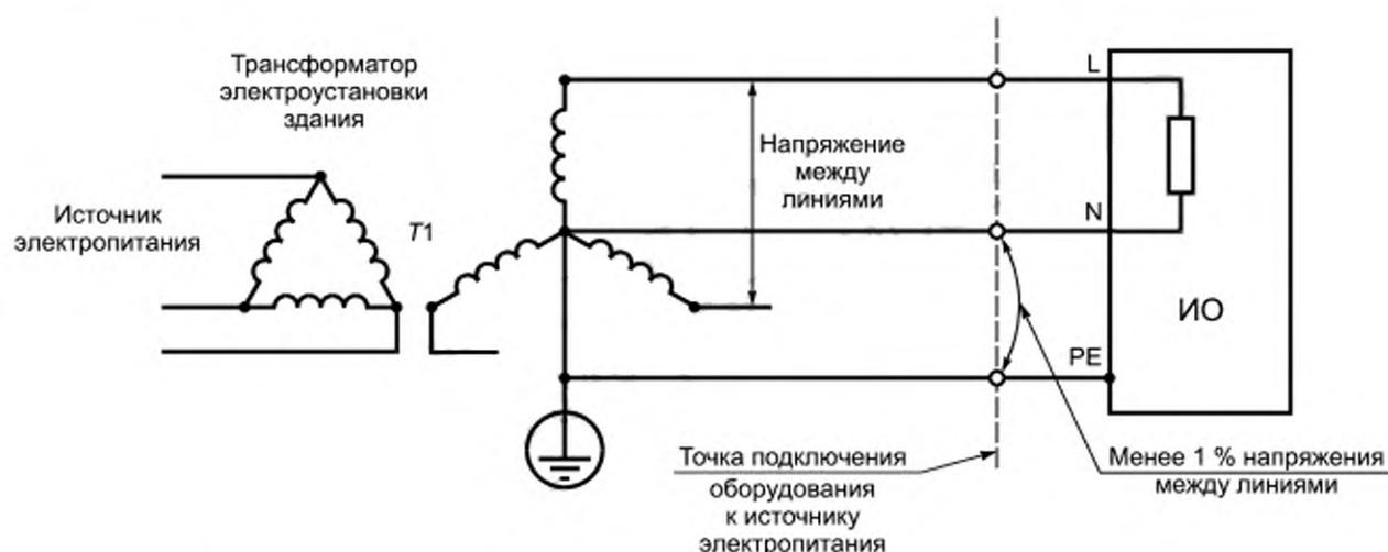
Рисунок 1 — Пример заземленной нейтрали, прямая подача электропитания
