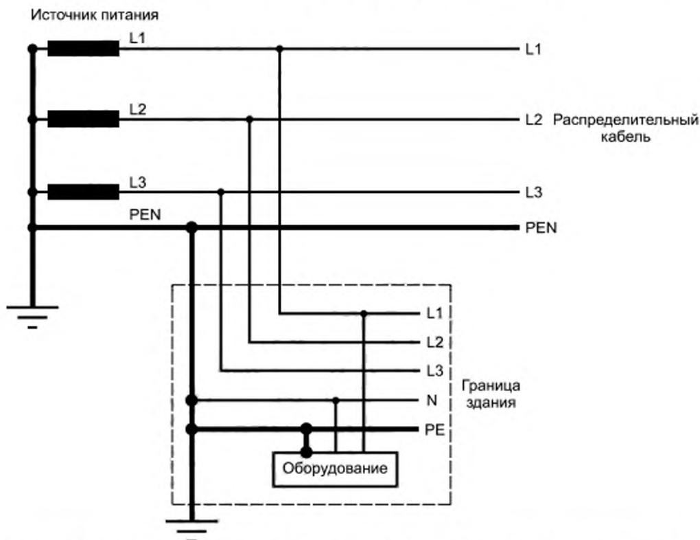
Функции нейтрального и защитного проводников совмещены в одном проводнике (PEN)
