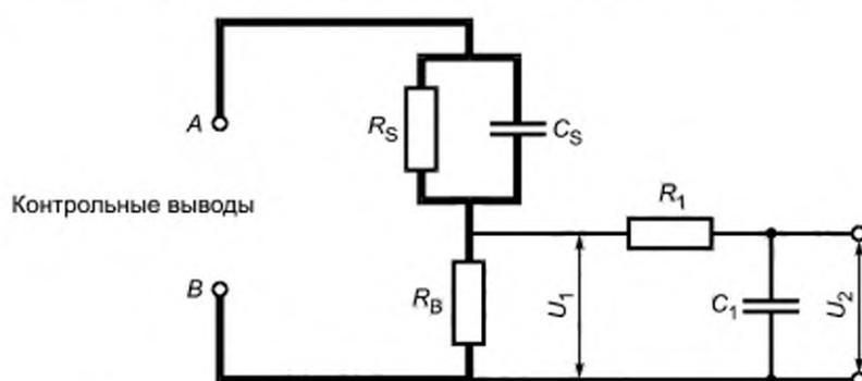
$$R_S = 1500 \text{ Ом}; \quad R_1 = 10000 \text{ Ом};$$
