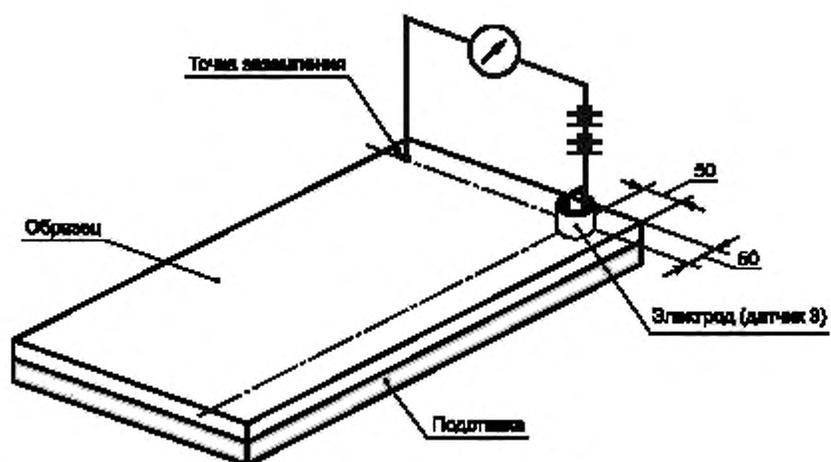
Рисунок 7 — Принцип измерения сопротивления к заземляемой точке
