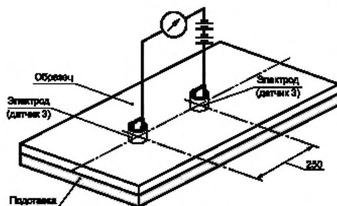
Рисунок 8 — Принцип измерения сопротивления от точки до точки
