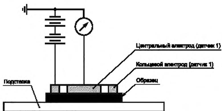
Рисунок 2 — Принцип подключения электродов для измерения поверхностного сопротивления
