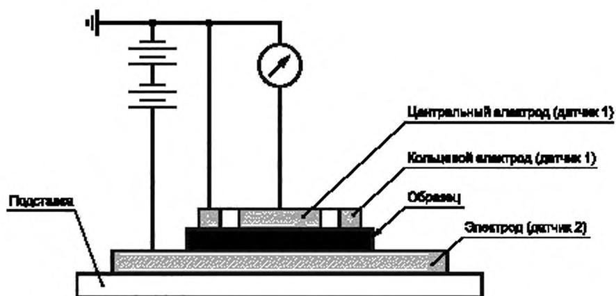
Рисунок 3 — Принцип подключения электродов для измерения объемного сопротивления
