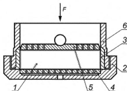
б) Для испытаний грунтов при оттаивании
