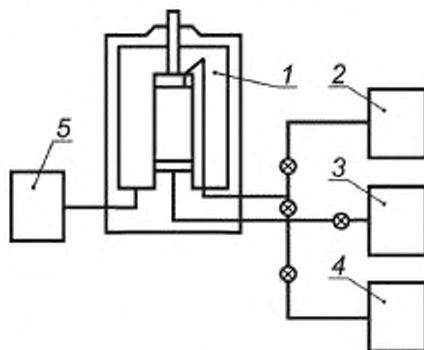
1 — камера прибора трехосного сжатия; 2 — блок измерения порового давления;
