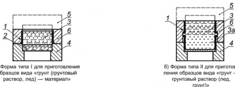
1 — рабочее кольцо срезного прибора, 2 — материал, 3 — грунт (лед, грунтовый раствор); 3а — грунт, 4 — опорное кольцо; 5 — крышка формы; 6 — защитное кольцо формы
