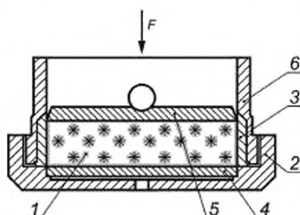
а) Для испытаний грунтов в мерзлом состоянии
