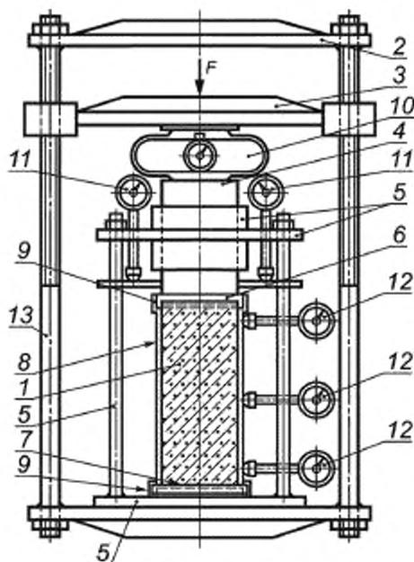
1 — образец грунта, 2 — неподвижная платформа, 3 — подвижная платформа, 4 — шток, 5 — направляющее устройство, 6 — верхний штамп, 7 — нижний штамп, 8 — паравлагонепроницаемая оболочка, 9 — резиновое прижимное кольцо, 10 — динамометр, 11 — измеритель продольных деформаций, 12 — измеритель поперечных деформаций, 13 — продольная тяга;  $F$  — нагрузка
