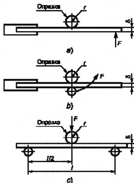
а) — один конец испытуемого образца закреплен, изгибающая сила ( $F$ ) приложена вблизи свободного конца образца; б) — один конец испытуемого образца закреплен, изгибающая сила ( $F$ ) приложена вблизи оправки; в) — оба конца испытуемого образца лежат на опорах, изгибающая сила ( $F$ ) приложена в центре испытуемого образца
