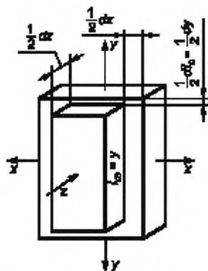
Рисунок В.2 — Схема для испытания на выдавливание
