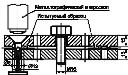
Рисунок 13 — Схема приспособления для крепления испытательного образца при испытании по способу В
