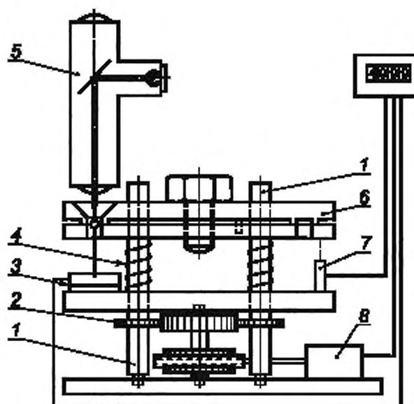
1 — стержень с резьбой; 2 — зубчатая передача; 3 — изолирующая прокладка; 4 — сжимающая пружина; 5 — металлографический микроскоп; 6 — приспособление для крепления испытуемого образца (см. рисунки 13, 14); 7 — потенциометр; 8 — двигатель
