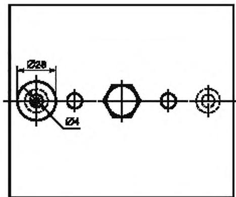
Рисунок 14 — Вид сверху приспособления для крепления испытательного образца при испытании по способу В
