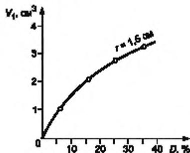
Рисунок С.2 — График зависимости для пластичности при испытании гидравлическим выдвливанием
