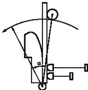
Рисунок 22 — Угол отклонения рычага ( $\alpha$ ) для изгибания образца
