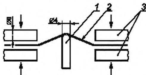
1 — опора, например, шпиндельная надставка со стальным шариком; 2 — испытываемый образец; 3 — приспособление для крепления образца
