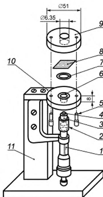
1 — микрометр; 2 — эпоксидная изоляция; 3 — шпиндельная надставка; 4 — стальной шарик; 5 — электрическая лампочка; 6 — паз; 7 — уплотнительное кольцо круглого сечения; 8 — испытуемый образец; 9 — верхняя пластина диаметром 51 мм, толщиной 8 мм с отверстием в центре диаметром 6,35 мм; 10 — нижняя пластина с отверстием в центре диаметром 6,35 мм; 11 — подставка
