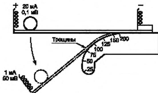
Рисунок 21 — Схема испытаний на изгиб на спиралевидной оправке
