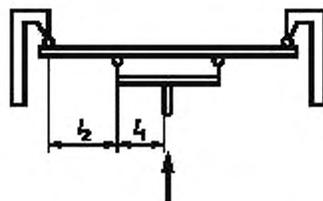
Рисунок 19 — Схема приложения нагрузок при испытании на двухугловом изгибе
