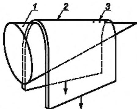
1 — коническая оправка; 2 — испытуемый образец; 3 — трещины
