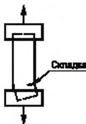
Рисунок 5 — Пример образования складок у образца из-за скручивания
