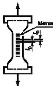
Рисунок 2 — Пример образца для испытаний (с нанесенными метками)
