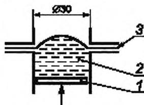
1 — поршень; 2 — вода; 3 — испытуемый образец
