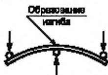
Рисунок 18 — Пример образовавшегося изгиба у образца
