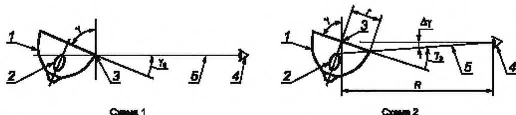
1 — светильник; 2 — источник света; 3 — центр поворота гониофотометра; 4 — глаз наблюдателя, 5 — линия зрения
