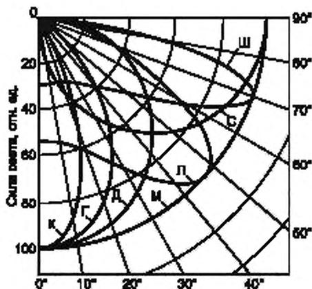
Рисунок 1 — Типы кривых силы света
