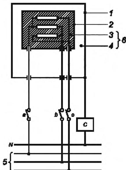
С — схема, приведенная на рисунке 10, для измерения тока утечки; 1 — доступная часть; 2 — недоступная металлическая часть; 3 — основная изоляция; 4 — дополнительная изоляция; 5 — трехфазное питание; б — двойная изоляция; N — нейтральный провод; а, б, с — выключатели
