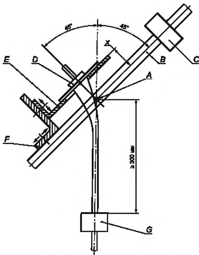
A — ось качания; B — качающийся элемент; C — противовес; D — образец; E — регулируемая несущая плита;
