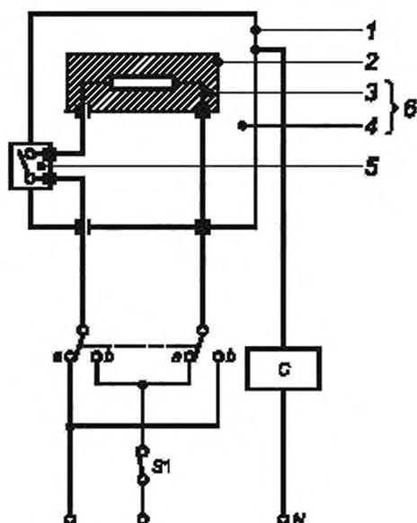
С — схема, приведенная на рисунке 10, для измерения токов утечки; S1 — сетевой выключатель испытываемого изделия; 1 — доступная часть; 2 — недоступная металлическая часть; 3 — основная изоляция; 4 — дополнительная изоляция; 5 — усиленная изоляция; 6 — двойная изоляция; а, б — положения селективного переключателя. N — нейтральный провод
