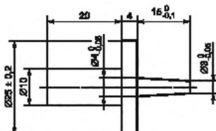
Рисунок 2 — Испытательный стержень
