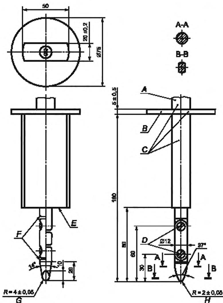
*A* – ручка; *B* – ограждение; *C* – изоляционный материал. *D* – соединения (шарниры); *E* – упорная поверхность; *F* – фаски (на всех углах), *G* – сферическая часть; *H* – цилиндрическая часть
