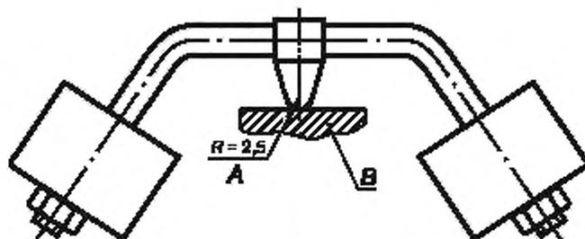
А — сферическая часть; В — испытуемый образец
