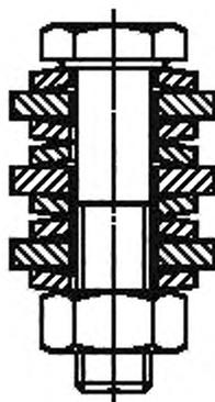
Рисунок 4 — Испытательное приспособление для тарельчатых пружинных шайб
