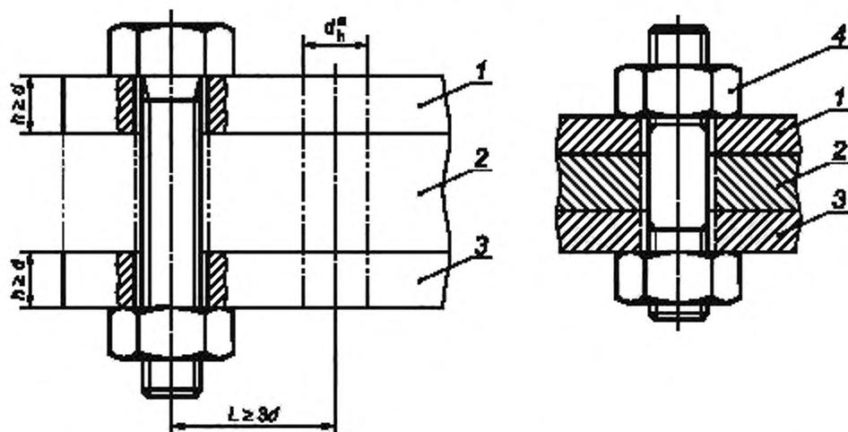
1 — верхняя пластина; 2 — листовое заполнение (для длинных болтов, винтов и шпилек); 3 — нижняя пластина;
