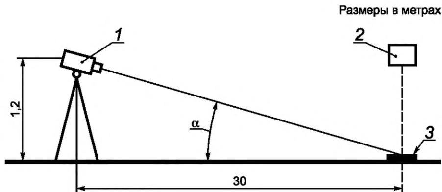
1 — фотоприемник, 2 — источник света типа D<sub>65</sub> по ГОСТ 7721; 3 — поверхность разметки
