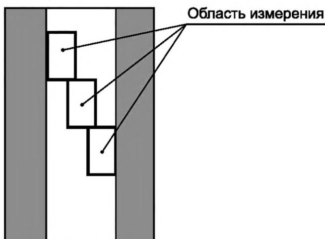
Рисунок 4 — Измерение коэффициента световозвращения полимерных лент
