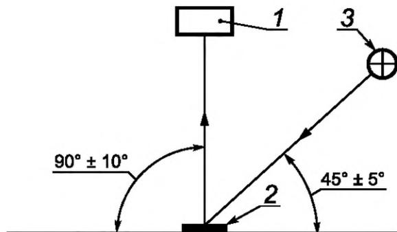
1 — спектрофотометр или колориметр, для измерения коэффициента яркости применяется яркомер;
