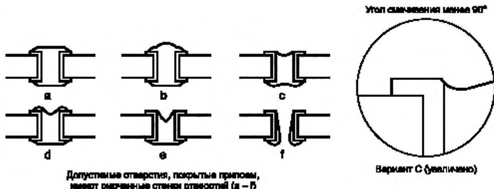
Допустимые отверстия, покрытые припоем, имеют смоченные стенки отверстий (а – г)
