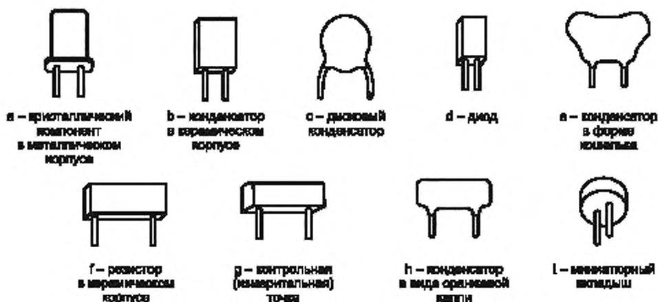
Рисунок 9 — Типовые компоненты с двумя радиальными выводами
