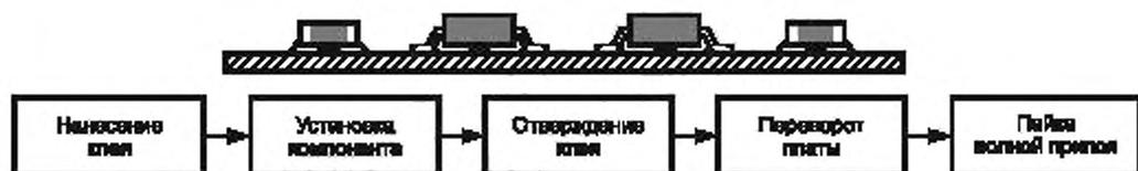
Рисунок 2 — Односторонний печатный узел. Пайка только погружением
