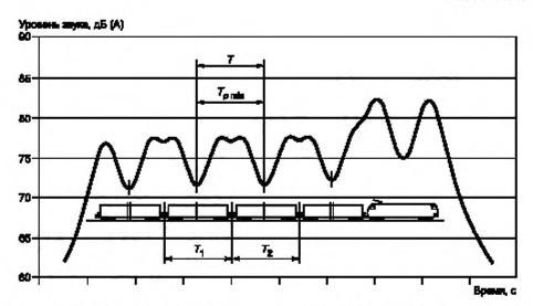
Рисунок 2 — Пример определения длительности измерения Т для единиц подвижного состава поезда (частей поезда)
