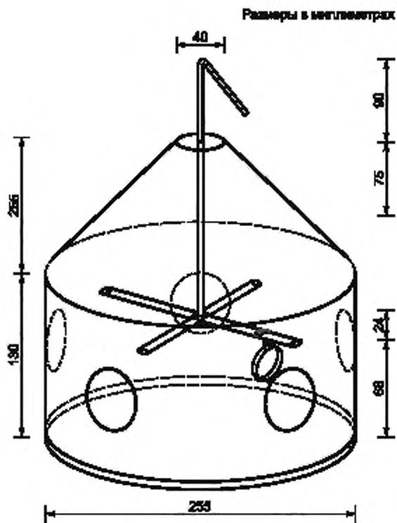
Защитное укрытие, схема которого приведена на рисунке А.3, не нашло широкого применения. На рисунке А.4 приведены схемы наиболее часто используемых укрытий, для которых имеются данные по характеристикам скорости ветра.
