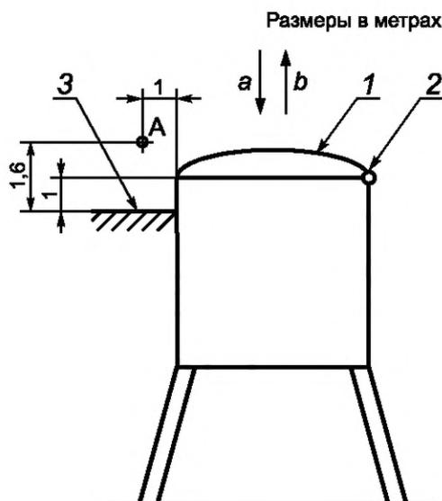
1 — крышка; 2 — петля; 3 — платформа; A — точка измерения;  $a$  — вход ткани;  $b$  — выход ткани
