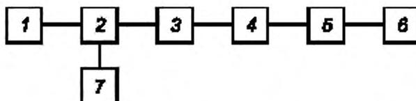
1 — измерительный генератор; 2 — фильтр; 3, 5 — коаксиальные соединители, 4 — эталонный делитель напряжения;
