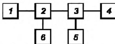
$f$  — измерительный генератор; 2, 3 — коаксиальные соединители; 4 — поверяемый вольтметр; 5 — эталонный вольтметр; 6 — эталонный частотомер
