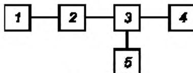
1 — измерительный генератор; 2 — фильтр; 3 — коаксиальный соединитель;
