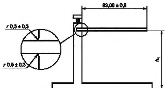
Рисунок 16 — Карта в зажимном устройстве до воздействия температуры
