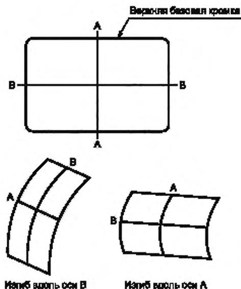
Рисунок 11 — Определение осей
