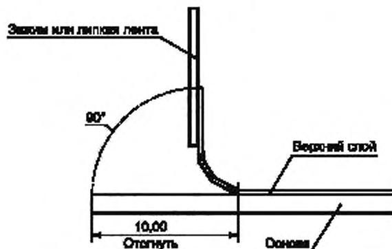
Рисунок 4 — Подготовка образца к испытанию
