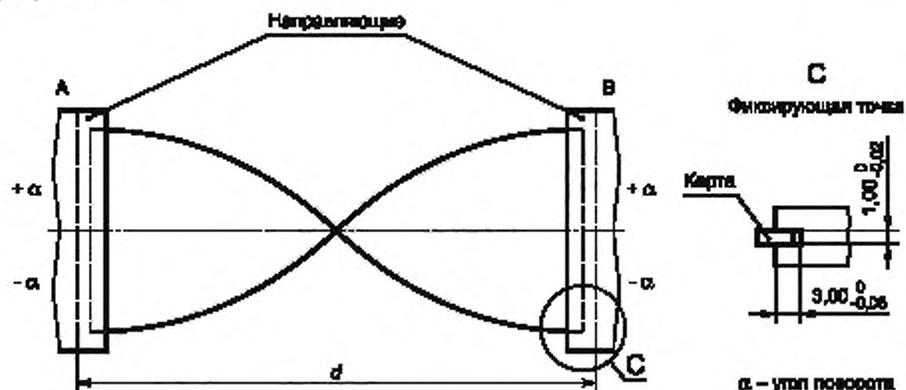
Рисунок 12 — Машина для испытания на скручивание
