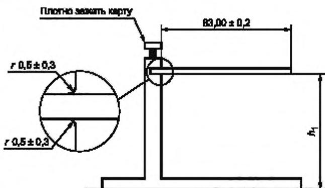
Рисунок 7 — Карта в зажимном устройстве до приложения нагрузки
