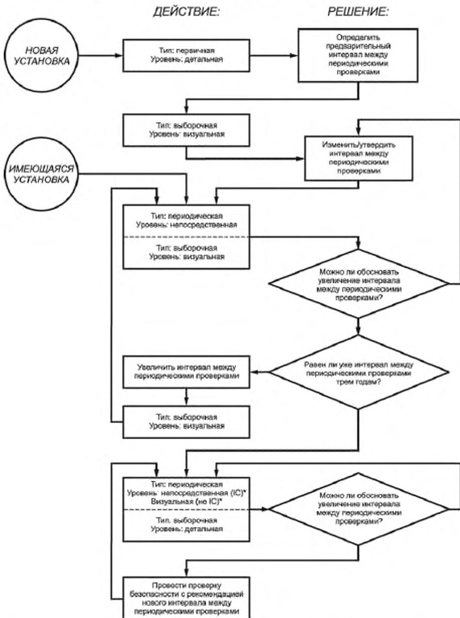
\* IC — способность к воспламенению в обычном режиме работы, т. е. когда в нормальном режиме работы встроенных компонентов электрооборудования возникают способные к воспламенению взрывоопасной среды дуговые разряды, искры или температура поверхности.
