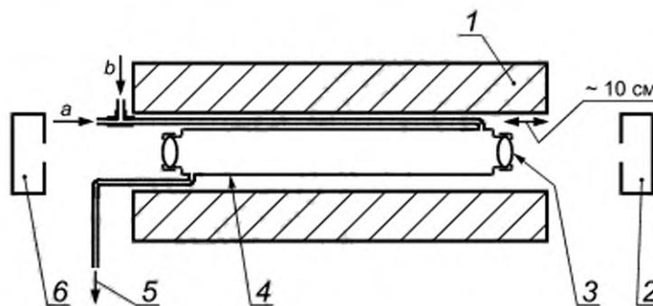
1 — термостат; 2, 6 — оптический элемент на монтажной раме; 3 — оптическое окно необходимой пропускной способности [ввернутый колпачок, например, из сапфира, флюорита или германия с прокладками из углеродистого волокна (например, флексикарб или «суперабзац»)]; 4 — компоненты из легированной стали; 5 — ловушка и устройство сброса (как на рисунке А.4а); а — жидкая вода; b — газ
