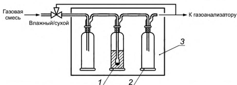
1 — минимальный объем воды; 2 — ловушка (размещают в камере только для температуры ниже 0 °С);
