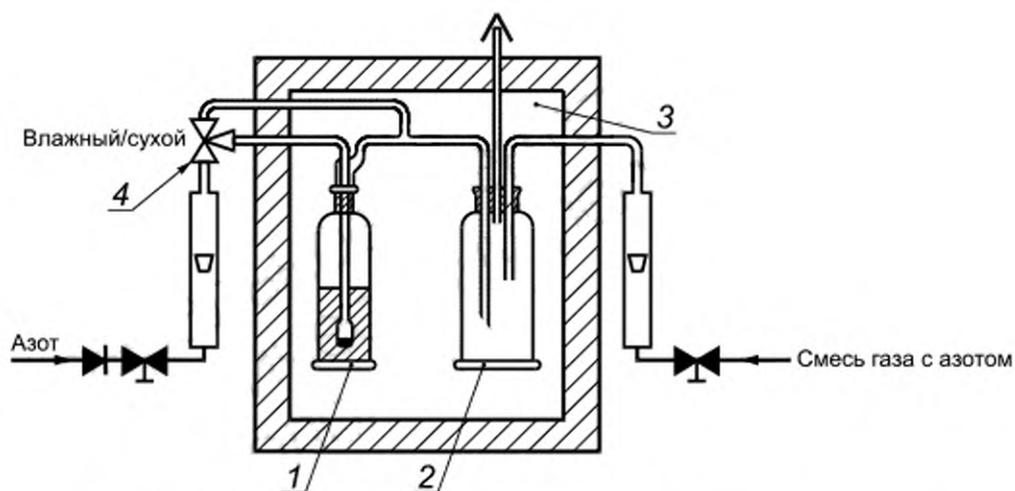
1 — сатуратор; 2 — смеситель; 3 — камера с температурой насыщения ( $T^{\circ}\text{C}$ ); 4 — клапан
