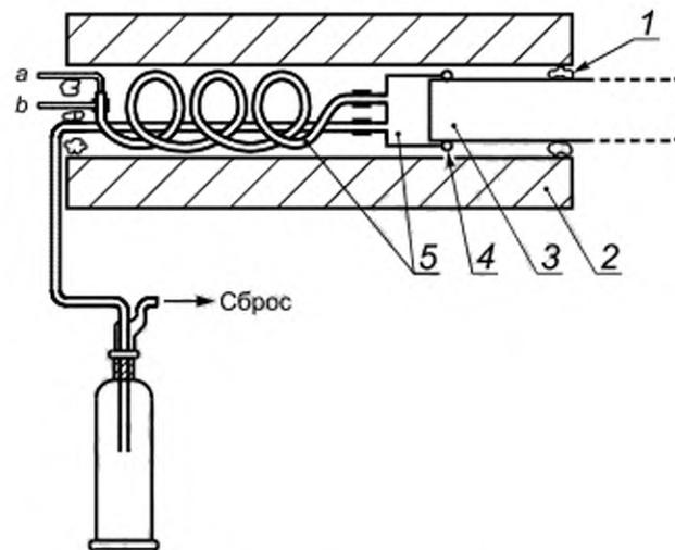
1 — минеральная вата; 2 — термостат; 3 — зонд испытуемого газоанализатора; 4 — уплотнение (например, из силикона), соответственно отбортованное; 5 — компоненты из легированной стали; а — жидкая вода; b — газ
