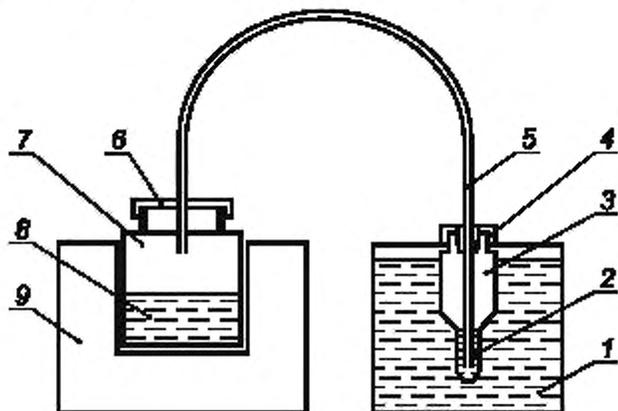
1 — емкость для охлаждения (водяная баня), заполненная холодной водопроводной водой; 2 — раствор соляной кислоты; 3 — приемная емкость; 4 — крышка приемной емкости; 5 — капилляр из кварцевого стекла внутреннего диаметра 530 мкм; 6 — крышка емкости для отгонки; 7 — емкость для отгонки; 8 — проба анализируемой воды; 9 — электрическая печь
