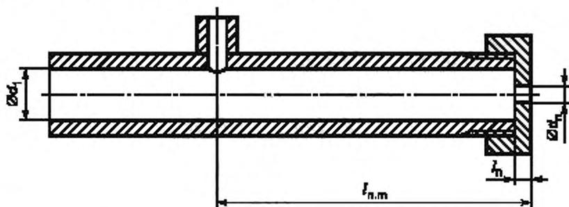
$d_n$  — диаметр отверстия сопла, равный  $(4 \pm 0,1)$  мм;  $l_n$  — длина отверстия сопла, равная  $(4 \pm 0,1)$  мм;  $d_1$  — внутренний диаметр трубки, равный  $(12,5 \pm 1)$  мм;  $l_{n,m}$  — расстояние между отверстием сопла и манометром, равное  $(80 \pm 1)$  мм
