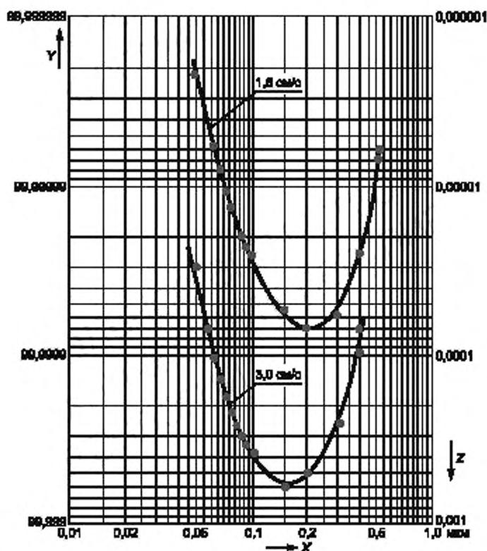
Рисунок 2 — Кривые зависимости эффективности  $E$  и проскока  $P$  фильтрующего материала сверхвысокой эффективности (ULPA) от диаметра  $d_p$  частиц для двух различных скоростей потока через материал
