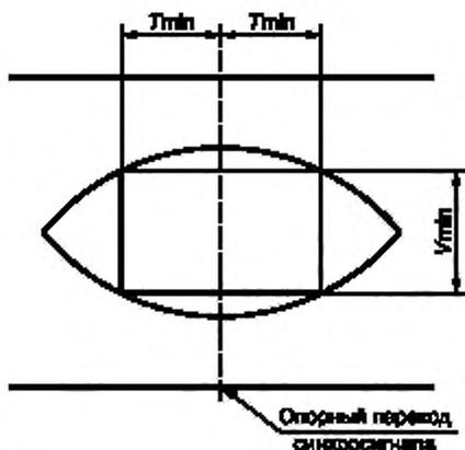
Примечание — Ширина окна глазковой диаграммы, в пределах которого данные должны быть правильно детектированы, включает в себя фазовое дрожание сигнала тактовой частоты ± 0,4  $T$ , синхронизацию данных ± 0,075  $T$  и скос за счет распространения в проводящих парах ± 0,18  $T$ .  $T_{min} = 0,3T$ ;  $V_{min} = 100$  мВ.
