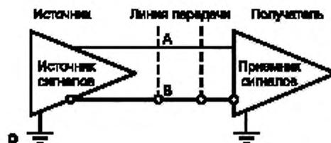
Рисунок 8 — Соединение источника сигналов и приемника сигналов
