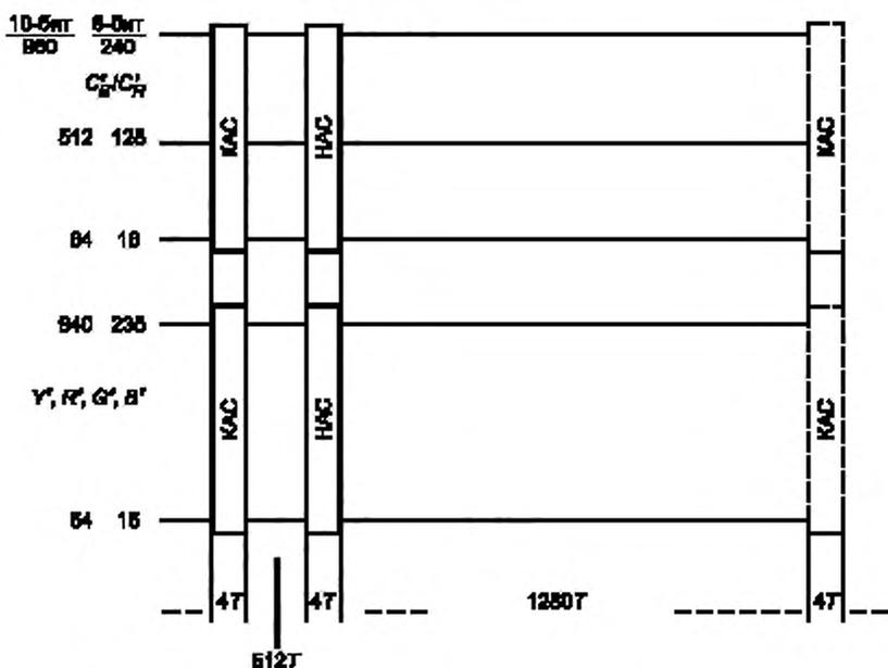
Рисунок 6 — Соответствие временных параметров цифровых сигналов
