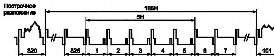
Рисунок 3 — Структура синхросигнала на интервале гашения поля
