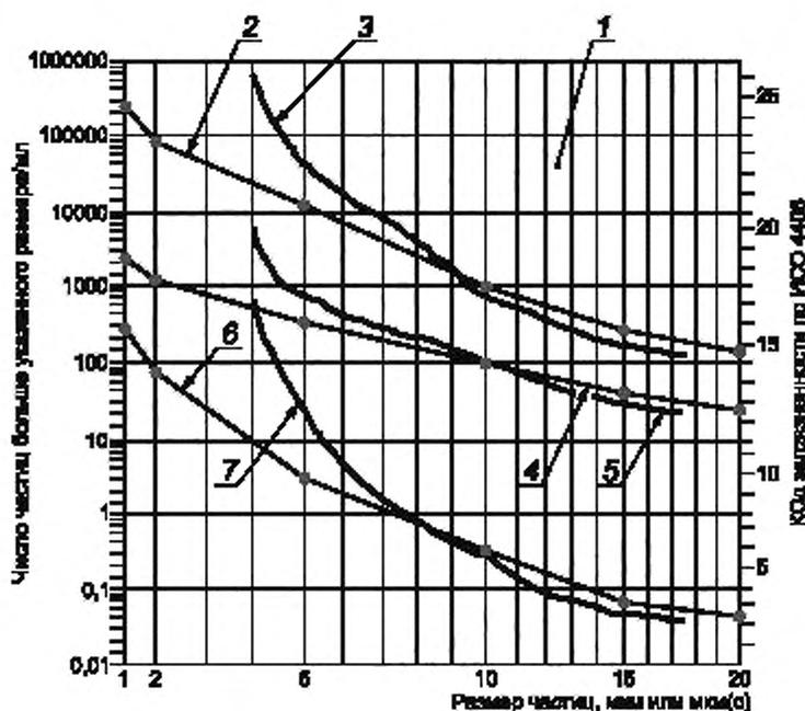
1 — распределения частиц по размерам и ИСО коды загрязненности гидравлической жидкости твердыми частицами, полученные с применением метода калибровки по ACFTD, установленного ИСО 4406:1987, и метода калибровки NIST, установленного ИСО 4406:1999; 2 — проба А = 9/3 (ACFTD); 3 — проба А = 17/10/3 (NIST); 4 — проба В = 16/13 (ACFTD); 5 — проба В = 20/16/12 (NIST); 6 — проба С = 21/15 (ACFTD); 7 — проба С = 26/21/15 (NIST)
