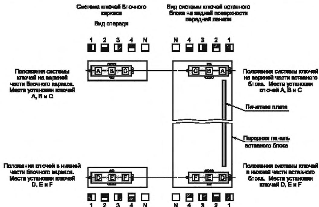
Примечание 1 — На задней установочной поверхности блочного каркаса/вставного блока буквы A, B и C находятся в нижней части, а D, E и F — в верхней. Порядок букв при этом представляет собой зеркальное отражение.
