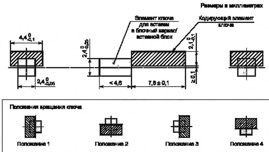
Рисунок 14 — Размеры ключа и положения при вращении ключа.
