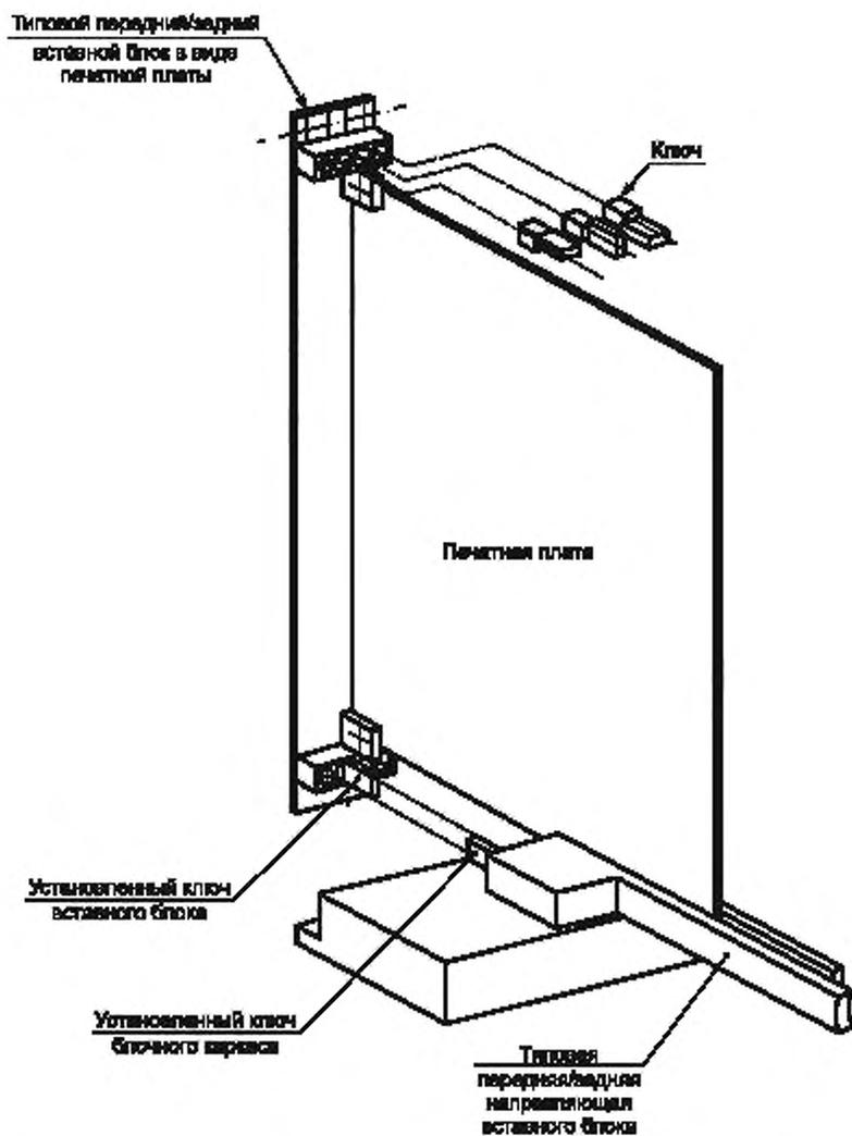
Рисунок 11 — Компоновка системы ключей кодирования для вставных блоков
