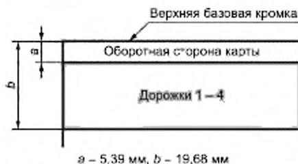
Рисунок 8 — Расположение и высота полосы при четырех дорожках
