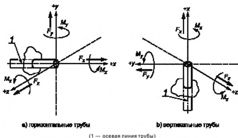
Рисунок 4 — Схема направления сил на трубы
