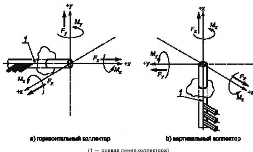
Рисунок 5 — Схема направления сил на коллекторы
