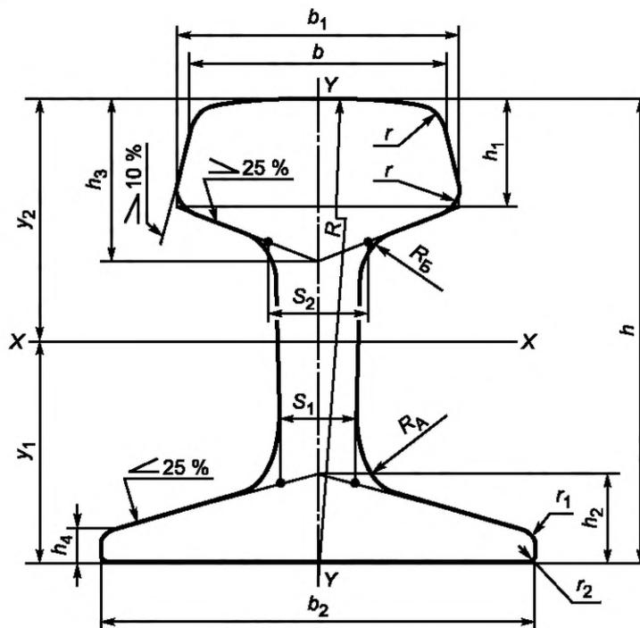
Рисунок 1 — Поперечное сечение рельсов типа КР70
