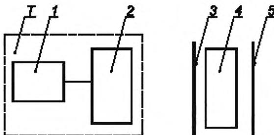
Т — испытуемый тепловизор (1 — блок регистрации, 2 — оптическая головка); 3 — тест-объект в виде мира с метками и отверстиями; 4 — излучатель-термостат, 5 — экран-фон
