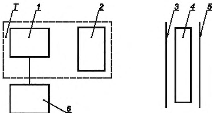
Т — испытуемый тепловизор (1 — блок регистрации, 2 — оптическая головка); 3 — щелевая мира; 4 — излучатель-термостат; 5 — экран-фон, 6 — осциллограф
