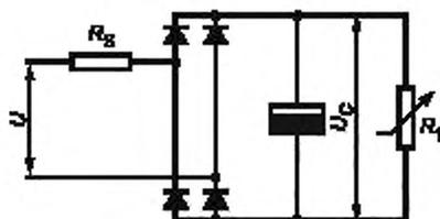
Рисунок М.4 — Эталонная нелинейная нагрузка
