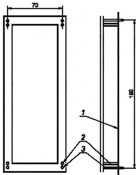
1 — образец для испытаний; 2 — разделительная ножка; 3 — палец крепления
