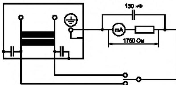
Рисунок 1 — Схема измерения тока утечки
