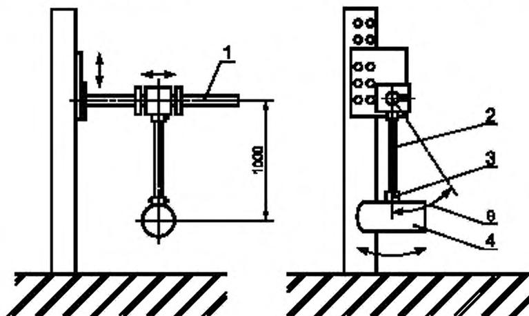
1 — направляющая штанга (не должна отклоняться более чем на 1,5 мм от горизонтальной оси); 2 — качающийся рычаг — стальная труба (ее массой можно пренебречь); 3 — воротник бойка (масса до 100 г); 4 — боек (масса 2500 г);  $\theta$  — угол вращения
