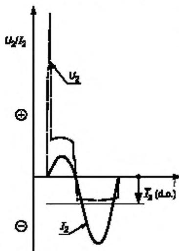
$U_2$  — сварочное напряжение;  $I_2$  — сварочный ток;  $\bar{I}_2$  — среднее арифметическое значение сварочного тока
