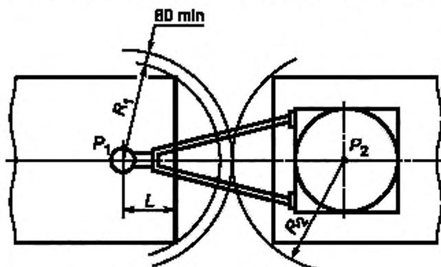
$R_1$  — радиус габарита задней части тягача (прицепа или полуприцепа для многоосного автопоезда);  $R_2$  — радиус габарита передней части прицепа;  $P_1$  — центр тягово-сцепного устройства;  $P_2$  — центр поворотного устройства прицепа;  $L$  — расстояние до центра тягово-сцепного устройства (для прицепов с центральной осью (осями) — не более 420 мм
