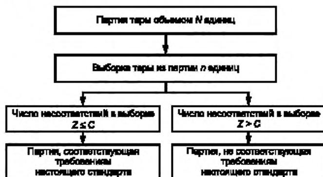
Рисунок 1 — Ход действия при применении планов контроля поставщика
