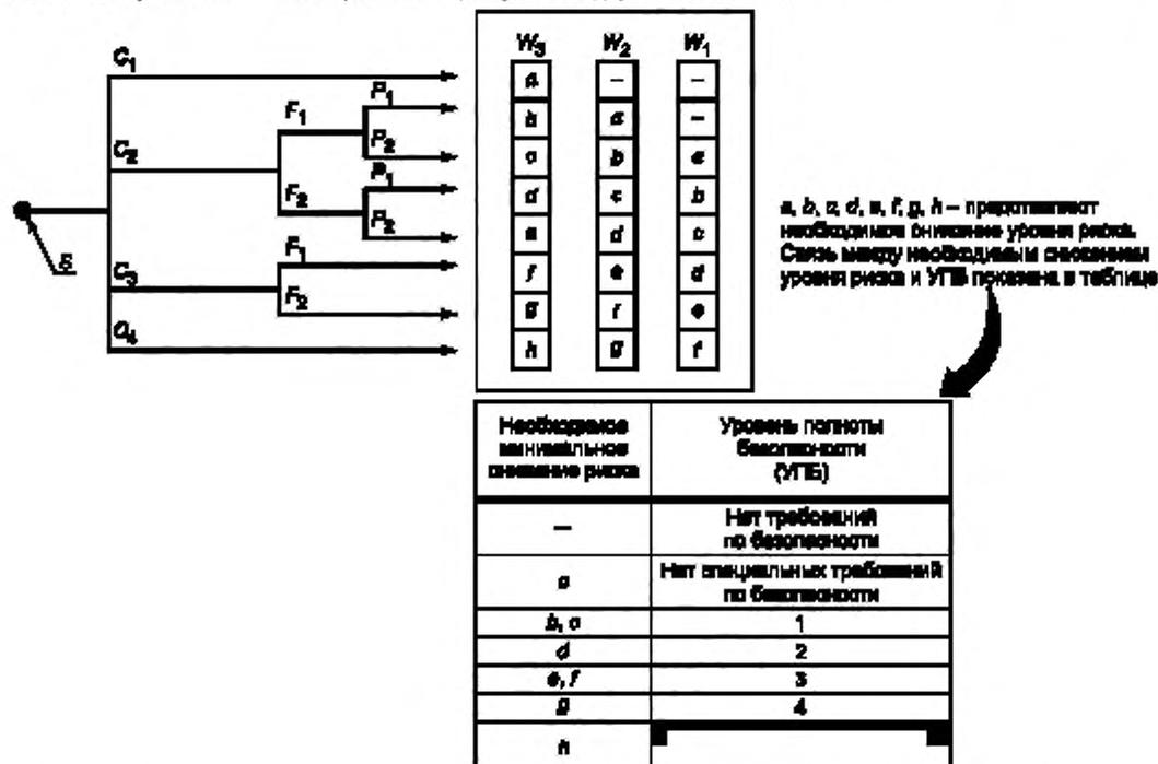
S — начальная точка для оценки снижения риска, C — значимость параметра риска, F — параметр риска частоты и длительности облучения, P — параметр риска возможности избежать опасности, W — вероятность нежелательного происшествия, a, b, c, ..., h — оценка требуемого снижения риска для ВКР лазера
