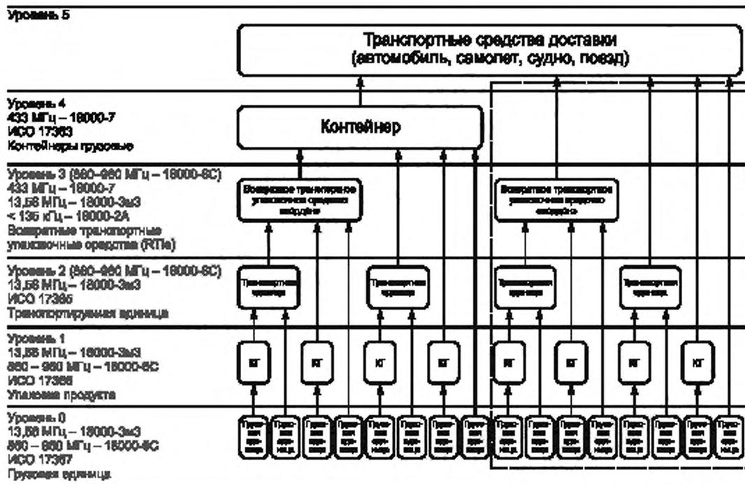
Рисунок 1 — Схематическая модель цепи поставок
