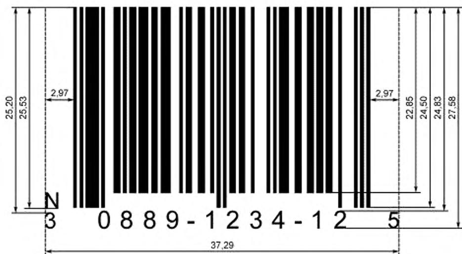
Рисунок Е.3 — Примеры вариантов исполнения символа UPC-A
