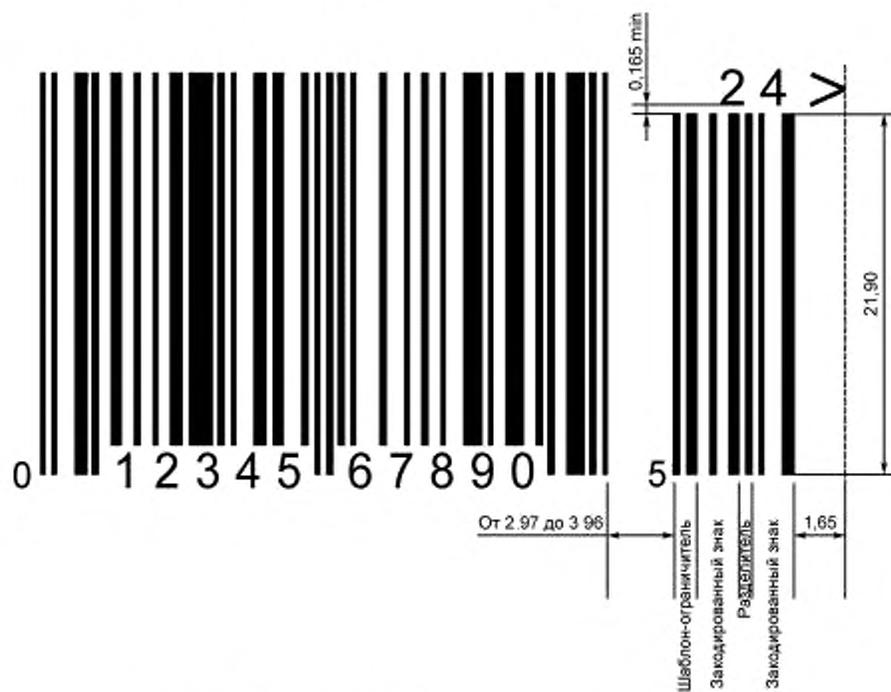
Рисунок Е.6 — Символ UPC-A с 2-разрядным дополнительным символом
