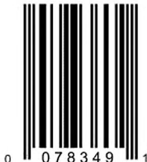
Рисунок 4 — Символ штрихового кода UPC-E (кодирующий "0 07834 00009 1" с отбрасыванием незначащих нулей)
