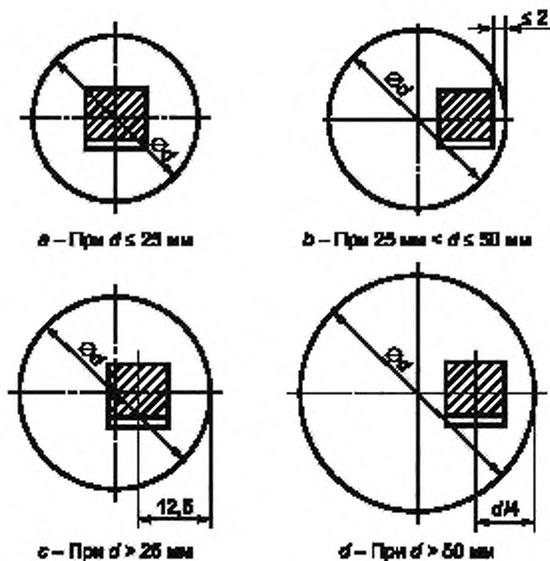
Рисунок Б.5 — Сортовой прокат круглого сечения и канатка.
