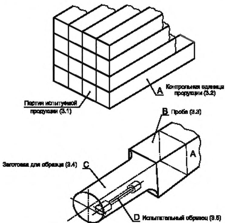
Рисунок 1 — Иллюстрация терминов, определенных в разделе 3
