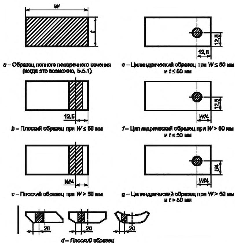
Рисунок Б.8 — Сортовой прокат квадратного и прямоугольного сечений. Место вырезки заготовок для образцов (испытательных образцов) для испытаний на растяжение (Б.5.1)
