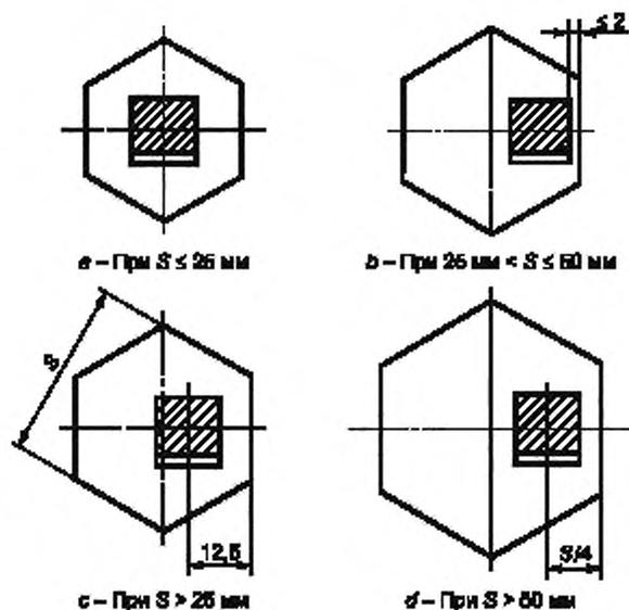
Рисунок Б.7 — Сортовой прокат шестигранного сечения.
