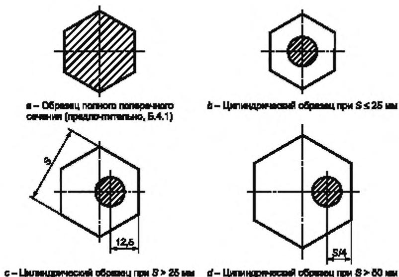
Рисунок Б.6 — Сортовой прокат шестигранного сечения.
