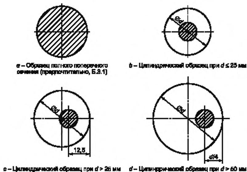
Рисунок Б.4 — Сортовой прокат круглого сечения и канатка.
