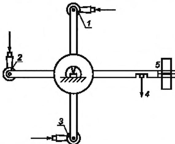
1, 2, 3 — контактные колесики и нажимные части в разных позициях измерений;
