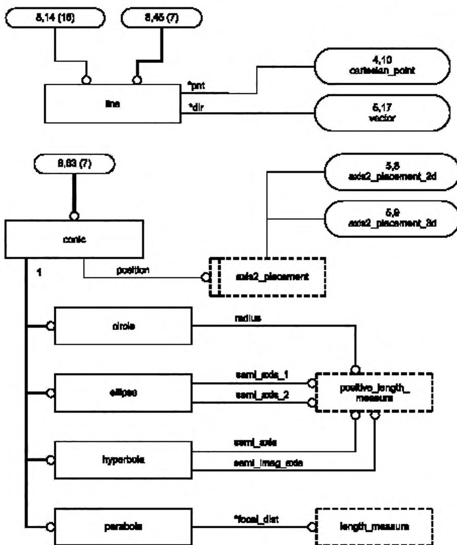
Рисунок С.8 — ПИК `non_manifold_surface_shape_representation` в формате EXPRESS-G (диаграмма 8 из 22)
