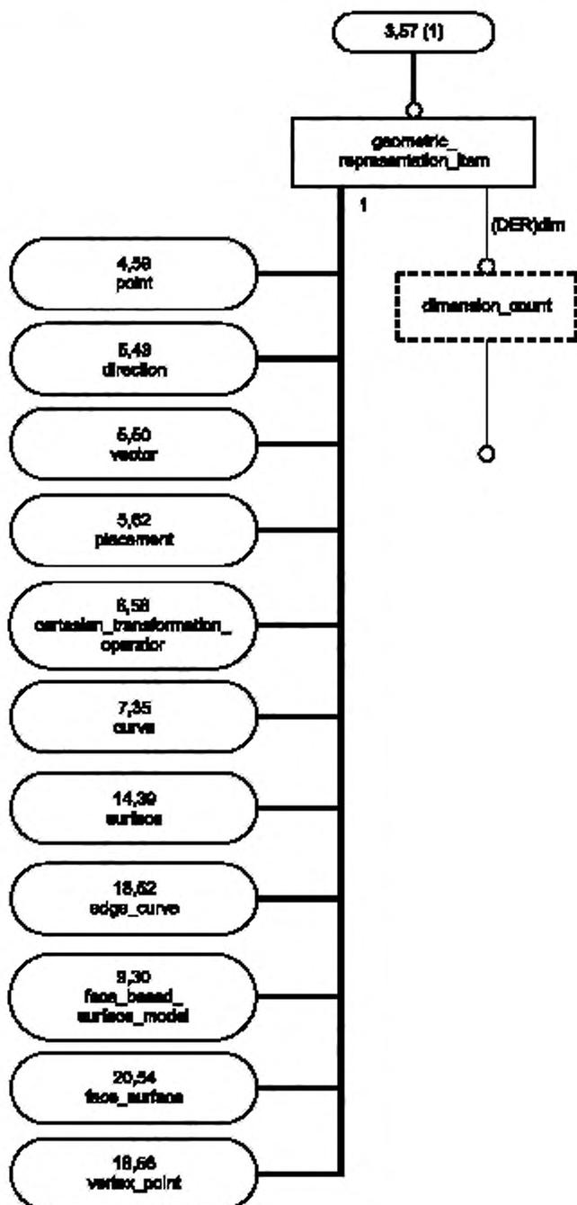
Рисунок С.3 — ПИК non\_manifold\_surface\_shape\_representation в формате EXPRESS-G
