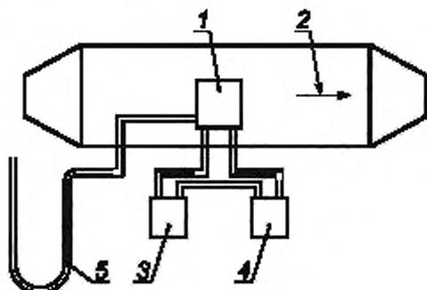
1 — фильтрующая полумаска на голове-манекене Шеффилда; 2 — направление потока воздуха; 3 — увлажнитель, нагреватель; 4 — дыхательная машина; 5 — манометр
