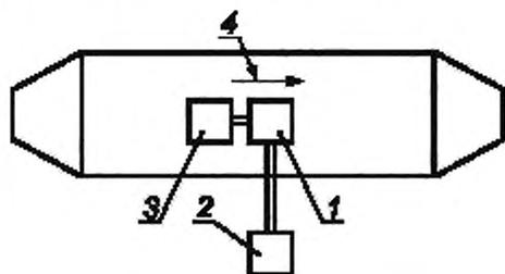
Рисунок 5 — Схема установки для методики В (все СИЗОД находятся в испытательной пылевой камере)
