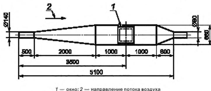
Рисунок 2 — Размеры рекомендуемой испытательной пылевой камеры
