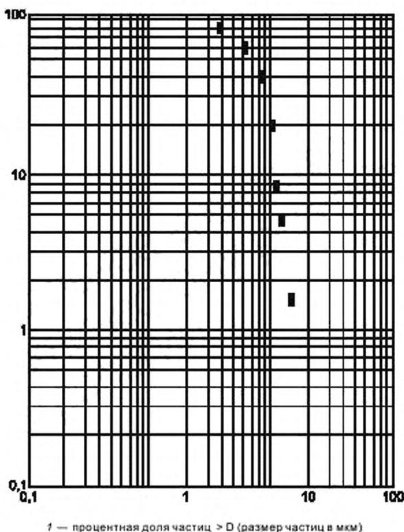
Рисунок 3 — Распределение размеров взвешенных в воздухе частиц порошка доломита (по массе) вблизи точки тестирования
