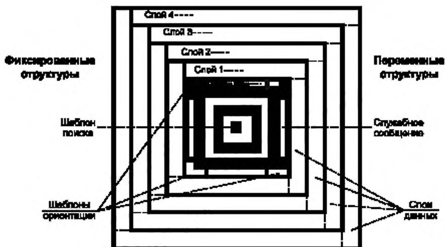
Рисунок 2 — Структура компактного символа Aztec Code
