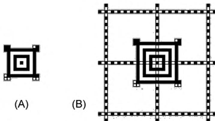
Рисунок Е.1 — Фиксированные шаблоны в компактном (А) и полноразмерном (В) символах Aztec Code
