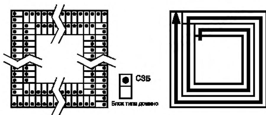
Рисунок 5 — Расположение и порядок следования блоков типа домино
