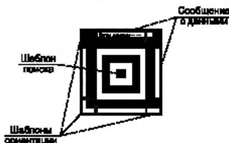
Рисунок А.2 — Структура символа Aztec Rune
