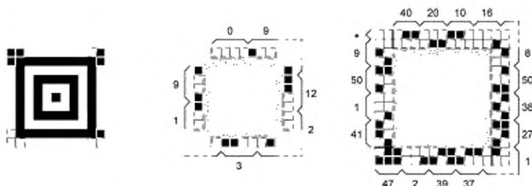
Рисунок G.1 — Последовательность построения символа Aztec Code
