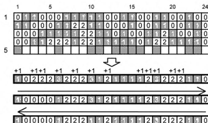
Рисунок С.6 — Последовательность и результаты сканирования строки 5
