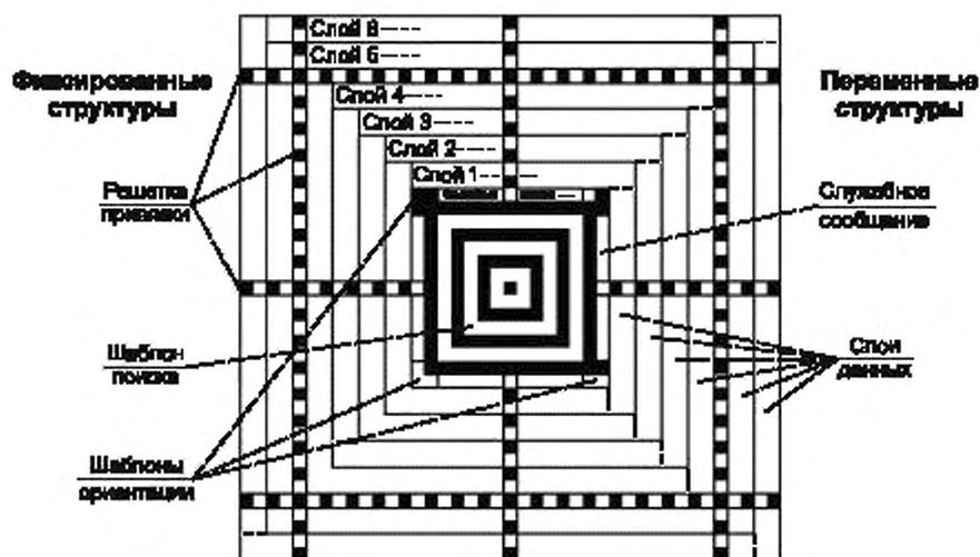
Рисунок 3 — Структура полноразмерного символа Aztec Code
