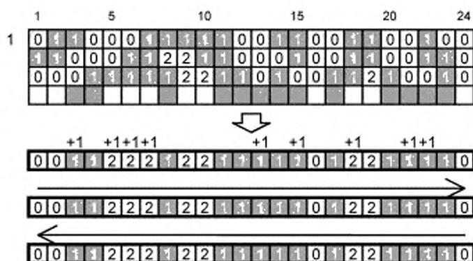
Рисунок С.5 — Последовательность и результаты сканирования строки 4
