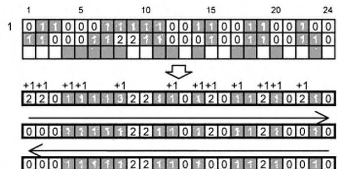
Рисунок С.4 — Последовательность и результаты сканирования строки 3
