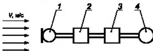
1 — испытуемый микрофон; 2 — микрофонный усилитель (5.3.2); 3 — 1/3-октавный фильтр (5.2.1); 4 — вольтметр (5.4.2)
