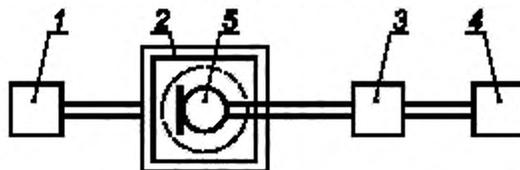
1 — генератор звуковой частоты (5.1.1); 2 — установка (5.9.9); 3 — микрофонный усилитель (5.3.2); 4 — анализатор гармоник (5.8.1); 5 — испытуемый микрофон
