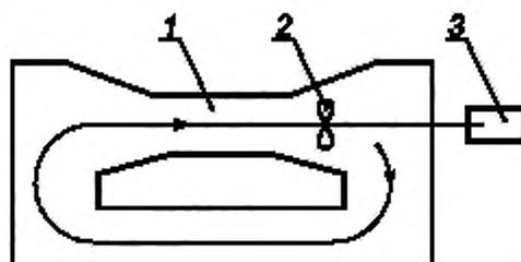
1 — рабочая часть; 2 — лопасти вентилятора; 3 — электродвигатель
