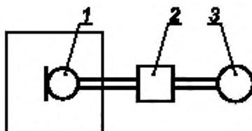
1 — испытуемый микрофон; 2 — измерительный усилитель (5.3.3); 3 — вольтметр (5.4.2)
