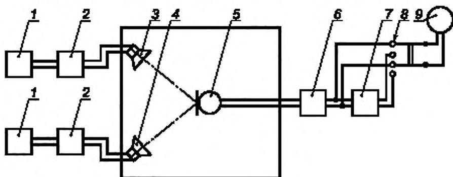
1 — звуковой генератор (5.1.1); 2 — усилитель мощности (5.3.1); 3 и 4 — громкоговорители (5.6.3 и 5.6.4); 5 — испытуемый микрофон; 6 — микрофонный усилитель (5.3.2); 7 — 1/3-октавный фильтр (5.2.1) со среднегеометрической частотой 80 Гц; 8 — переключатель; 9 — вольтметр (5.4.1)
