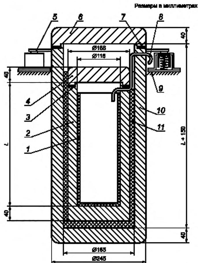
1 — звукопоглощающая облицовка; 2 — внутренний корпус; 3 — резиновая прокладка внутреннего корпуса; 4 — крышка внутреннего корпуса; 5 — виброизолятор (4 шт.); 6 — крышка внешнего корпуса; 7 — резиновая прокладка внешнего корпуса; 8 — сигнальный кабель; 9 — плоскость основания; 10 — внешний корпус; 11 — заполнение из демпфирующего материала
