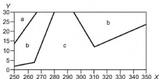
X — температура, К; Y — давление, МПа; а — диапазон относительной расширенной неопределенности  $\pm 0,4\%$ ; b — диапазон относительной расширенной неопределенности  $\pm 0,2\%$ ; с — диапазон относительной расширенной неопределенности  $\pm 0,1\%$
