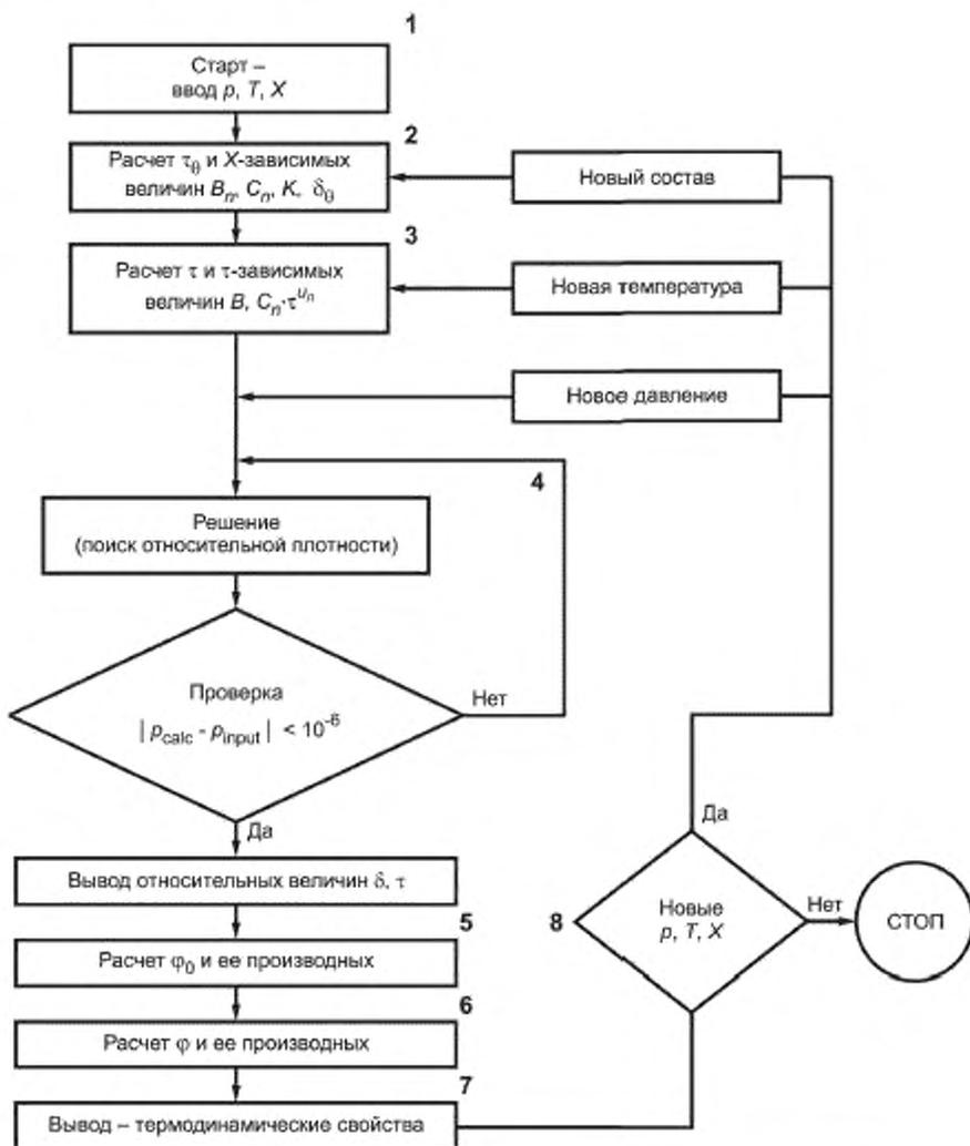
Рисунок F.1 — Блок-схема процесса вычислений термодинамических свойств
