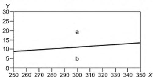
X — температура, К; Y — давление, МПа; а — диапазон относительной расширенной неопределенности  $\pm 0,08$  %; б — диапазон относительной расширенной неопределенности  $\pm 0,04$  %
