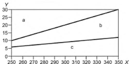
X — температура, К; Y — давление, МПа; а — диапазон относительной расширенной неопределенности  $\pm 2,0\%$ ; b — диапазон относительной расширенной неопределенности  $\pm 0,8\%$ ; c — диапазон относительной расширенной неопределенности  $\pm 0,2\%$
