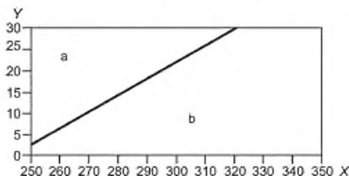
X — температура, К; Y — давление, МПа; а — диапазон относительной расширенной неопределенности  $\pm 0,20\%$ ; b — диапазон относительной расширенной неопределенности  $\pm 0,05\%$
