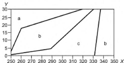
X — температура, К; Y — давление, МПа; а — диапазон абсолютной расширенной неопределенности  $\pm 3$  кДж/кг; b — диапазон абсолютной расширенной неопределенности  $\pm 2$  кДж/кг; с — диапазон абсолютной расширенной неопределенности  $\pm 1$  кДж/кг
