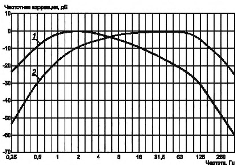
1 — функция частотной коррекции для ускорения; 2 — функция частотной коррекции для скорости
