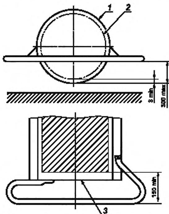
1 — защитное устройство; 2 — окружность вращения режущей кромки рабочего инструмента;
