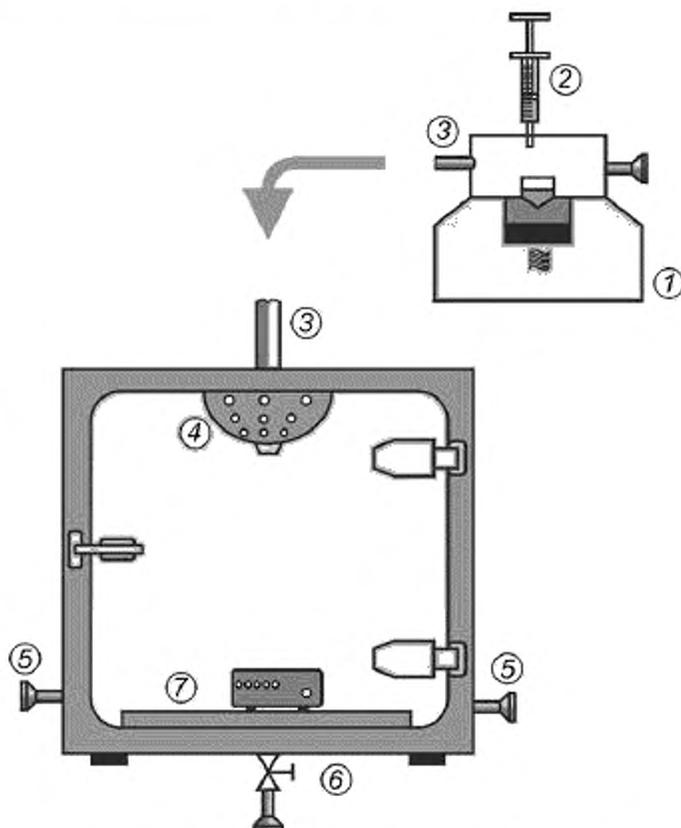
1 — сверхзвуковая аэрозольная установка; 2 — градуированный шприц; 3 — трубка; 4 — воронка с отверстиями;
