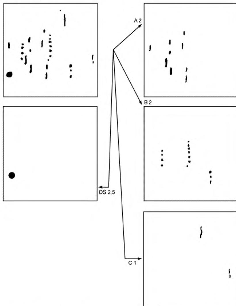
Верхний слева чертеж на рисунке В.1 показывает поле, наблюдаемое при увеличении  $\times 100$ , на котором можно различить четыре типа неметаллических включений. В зависимости от их формы и распределения эти включения классифицируют как следующие четыре типа:
