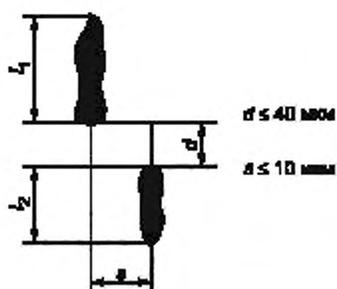
Рисунок 8 — Включения типов А и С
