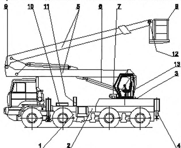
1 — базовое шасси; 2 — опорная рама; 3 — поворотная рама; 4 — выносные опоры; 5 — стрела (комбинированная),
