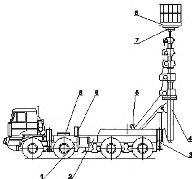
1 — базовое шасси; 2 — опорная рама; 3 — выносные опоры; 4 — стрела вертикального телескопирования; 5 — механизм
