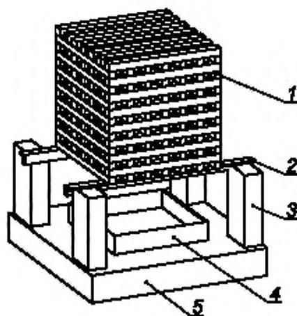
1 — деревянные бруски, 2 — стальной уголок, 3 — бетонный (металлический) блок, 4 — поддон, 5 — весы платформенные
