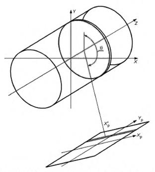
Примечание — Фиксированная координатная система X, Y, Z имеет начало в центре ТОМОГ-РАФИЧЕСКОГО ОБЪЕМА (показан в виде цилиндра), причем z-ось является СИСТЕМНОЙ ОСЬЮ. Координатная система с проекциями  $X_p$ ,  $Y_p$  показана для проекции угла  $\theta$ . Для каждого  $\theta$  проекция в одном измерении отмеченного среза объекта имеет адресный диапазон, который показан на рисунке (заштрихован). Внутри этого диапазона ЦЕНТР ВРАЩЕНИЯ проецируется в  $X_p$  (смещение).
