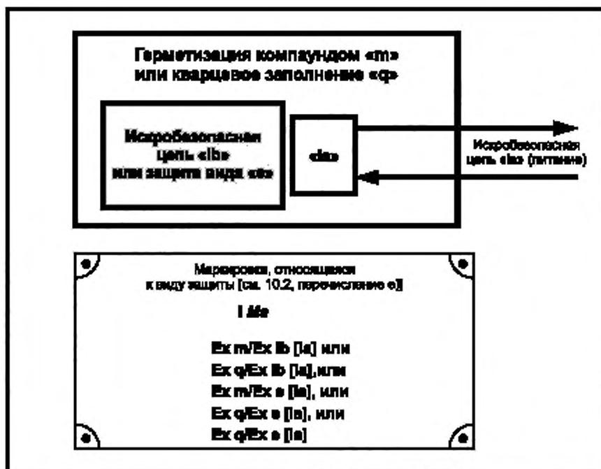
Рисунок 6 — Оборудование уровня взрывозащиты  $M_a$  (искробезопасная цель «ib» или защита вида «e» внутри оболочки с герметизацией компаундом «tm», или кварцевым заполнением «q»)
